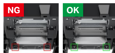
Comprobación del montaje del panel de instrumentos
