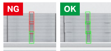
Comprobación de desfase del núcleo de motores
