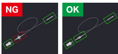
Comprobación del montaje de productos farmacéuticos en tubo
