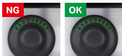
Confirmación de la impresión en piezas de caucho
