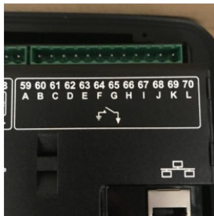
**Fig. 9 Entradas digitales módulo DSE8620**
