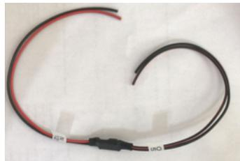
Fig 8 Circuito regulador de voltaje 12-24 Volts CD a 5 VCD
