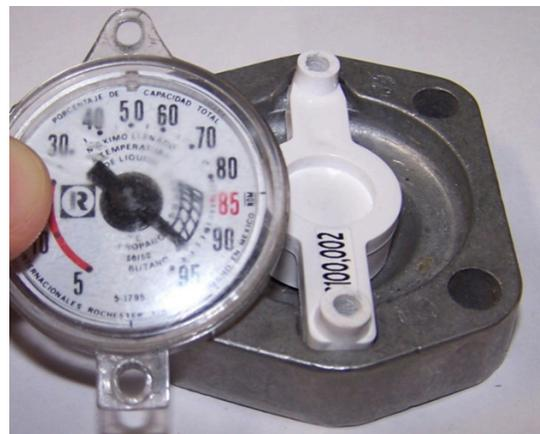
Fig 6 Carátula desmontada del cuerpo del flotador
