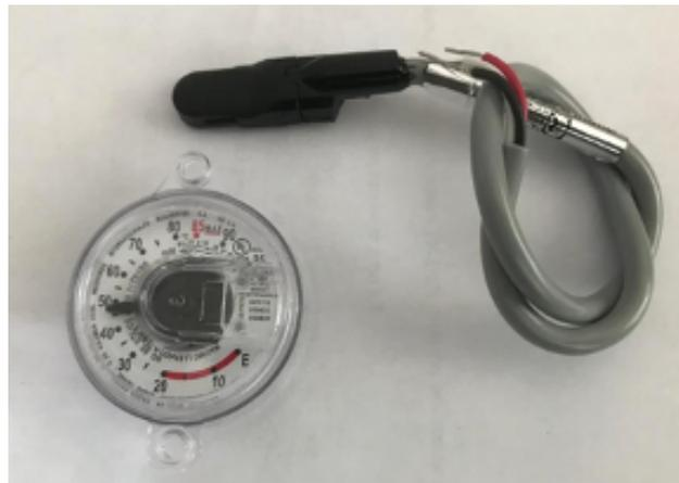
Fig 1 Sensor R3D-E y medidor de carátula
