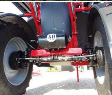
Trois variantes de suspension au choix : non suspendue, tampon élastomère, pneumatique à correction de niveau
