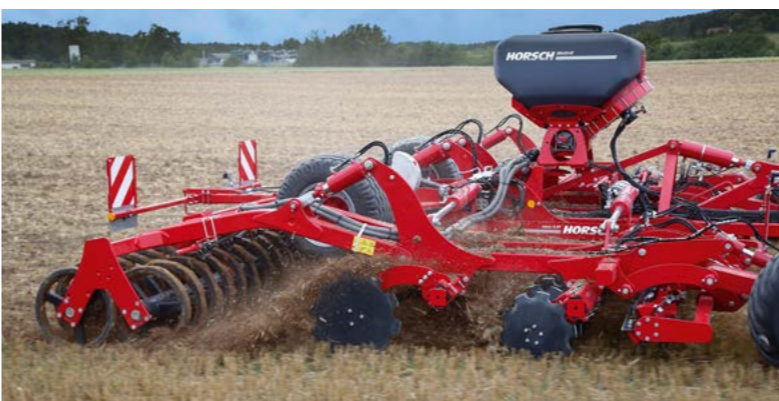
Joker RT avec MiniDrill en option : des éclateurs répartissent la semence devant le packer
