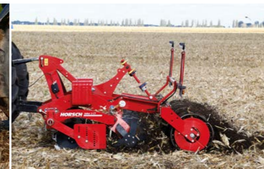
Dégagement maximal grâce au montage des disques par paire
