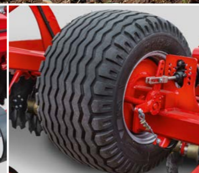
Essieu de transport Pour circuler en toute sécurité ; système de freinage en option
