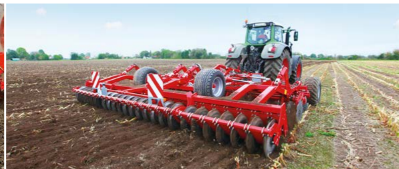
Le rouleau packer permet la réduction des mottes et une consolidation intensive du sol
