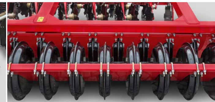
Rouleau SteelDisc double pour un ré-appui optimal sur les sols les plus difficiles
