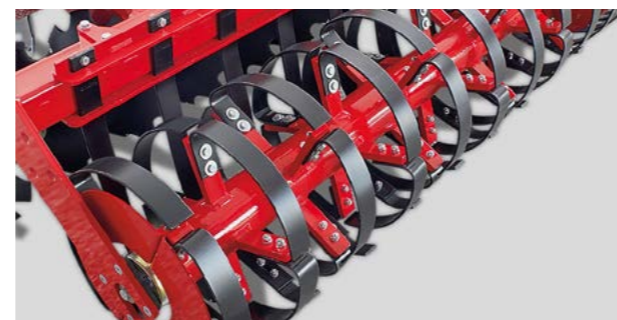
Rouleau RollFlex avec lames ressort
