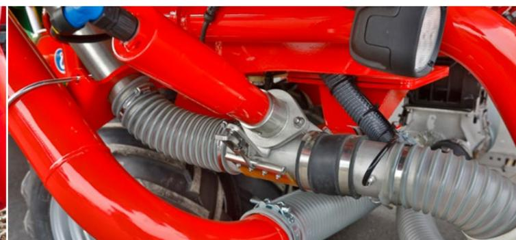
Distribution microgranulateur (doseur à vis sans fin)
