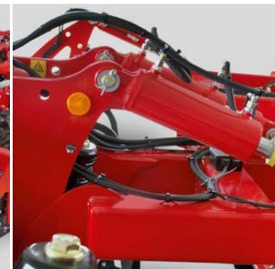
Réglage de profondeur par cales d'épaisseur
