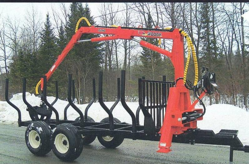
Le modèle de chargeuse à bois Woody 150-HD est idéal pour les camions et tracteurs de 50 HP et plus. Avec sa capacité de levage supérieure à ces concurrents, ce modèle est un excellent choix pour les producteurs les plus exigeants. Le modèle 150-HDT est muni d'une extension de mât télescopique de 3'.
