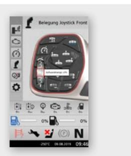
La fonction de configuration personnalisée des touches sur le joystick ErgoControl peut être sélectionnée facilement sur l'écran d'affichage du véhicule
