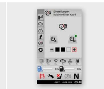
Les réglages des filtres cabine cat. IV : mode automatique ou manuel avec ajustement de l'intensité
