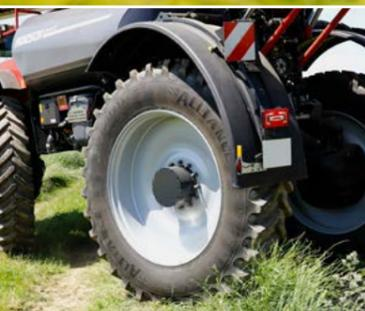
Grandes roues jusqu'à 2,05 m de diamètre
