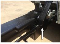
PULL PIN LEVER AT TOP OF (D) THEN PULL(C,D) BACK AND DOWN UNTIL PIN LOCKS BACK INTO PLACE WHERE SHOWN. SITTING ON UNIT CAN HELP THE PIN LOCK. BE CAREFUL AS THE UNIT IS SPRINGLOADED SO IF NOT LOCKED WILL COME UP VERY QUICKLY.
