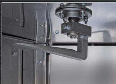
Sistema di rotazione del carrello con gancio superiore standard fino al modello INDUSTRY 88.
