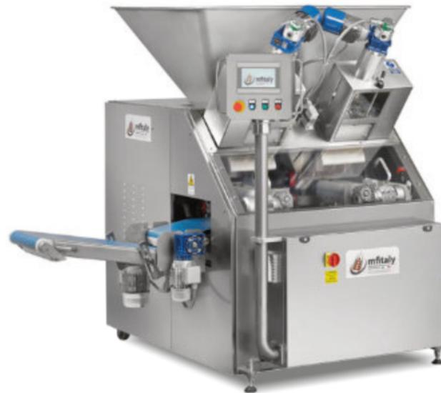
Spezzatrice Volumetrica modello SVP-P4 il modello maggiorato industriale per produzioni da 2500 fino a 5000 pz/h.
