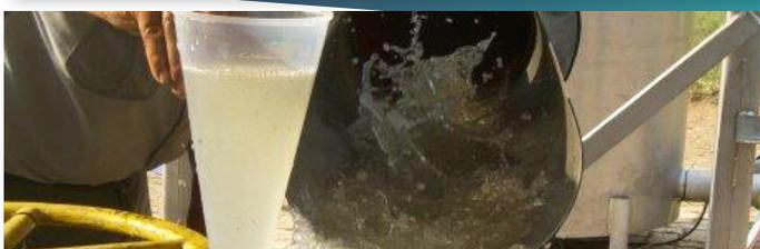
As partículas de sujeira, removidas durante a fase de lavagem, permanecem dentro do adensador de tambor e são descarregadas junto com o lodo adensado, garantindo um filtrado particularmente limpo (captura de alta eficiência) de até > 98%.
