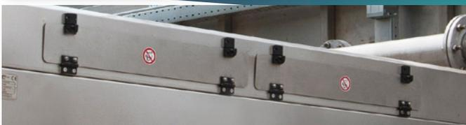
O filtro é completamente fechado, impedindo assim saída de aerossol e cheiro. É equipado com painéis de inspeção removíveis para manutenção simples e rápida.
