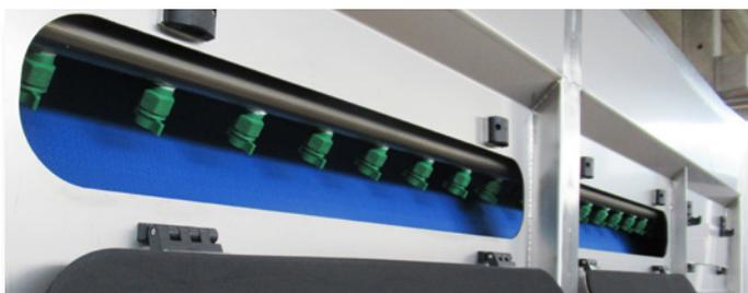
Um sistema automático de lavagem mantém a tela do filtro limpa usando bicos de spray especialmente projetados pela TEKNOFANGHI, que usam menos água que outros bicos padrão do mercado. Para limpeza rápida dos bicos, eles podem ser desmontados e limpos com facilidade, sem necessidade de ferramentas.
