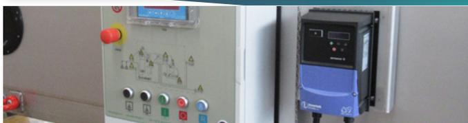
Este design permite controle simples do processo de adensamento com ajuste da velocidade rotativa que permite aumento/redução do tempo de retenção para se atingir o adensamento ideal.
