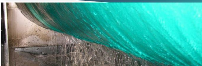
A tela do filtro tem longa duração já que não fica sob tensão de tração já que é fixada diretamente no parafuso. Combinados com a estrutura simples e robusta da máquina, esses adensadores se tornam extremamente confiáveis.
