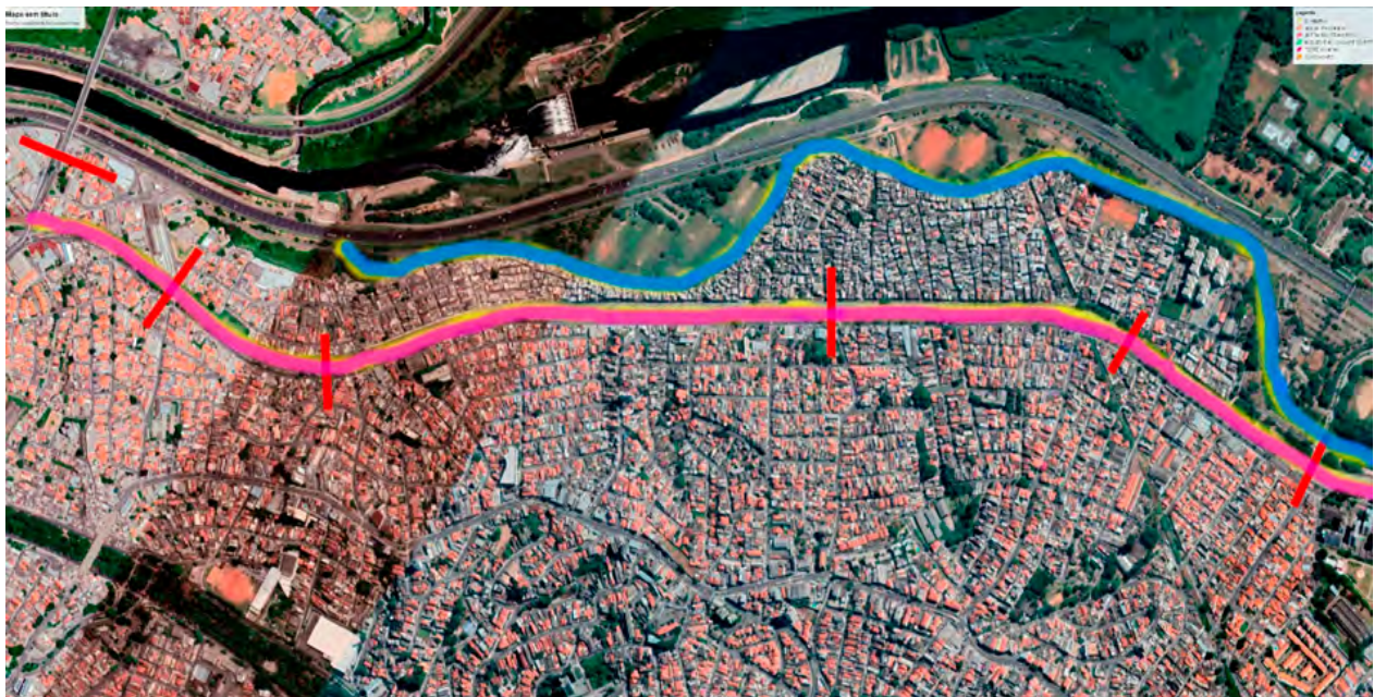
Fig. 7: Linha da CPTM (em rosa) cria uma barreira física contínua que separa os bairros da área de estudo da Colina do Cangaíba, a sul. O canal de circunvalação (em azul) separa a área do Plano de Bairro do Parque Ecológico do Tietê, a norte. As linhas vermelhas indicam os únicos seis acessos, entre pedestres e viários, à área do Plano de Bairro. / Fonte: Q.Urb, 2022.
