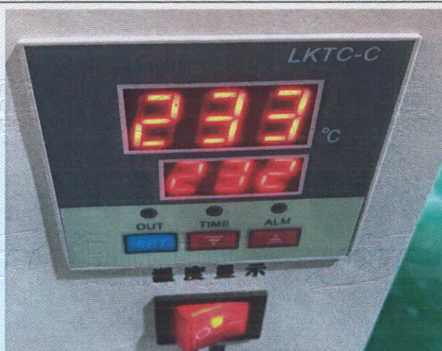
高温测试温度 (232°C) /Test temperature @ High temperature (232°C)
