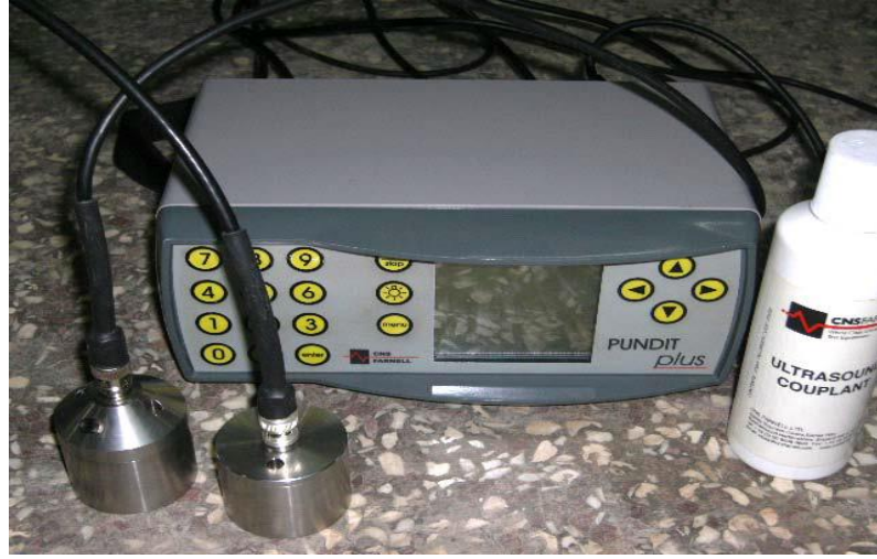
Şekil 33. Pundit Plus Model PC1006 Ultrasonik Test Cihazı
