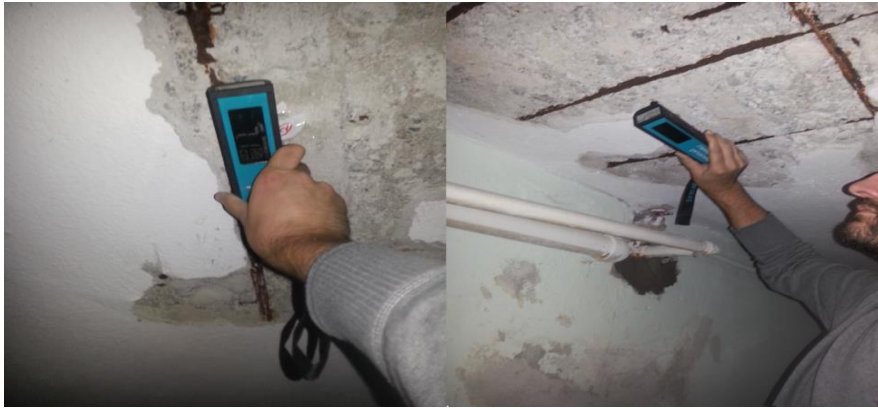
Şekil 76. Tavanda elektrik özdirenç ölçümü
