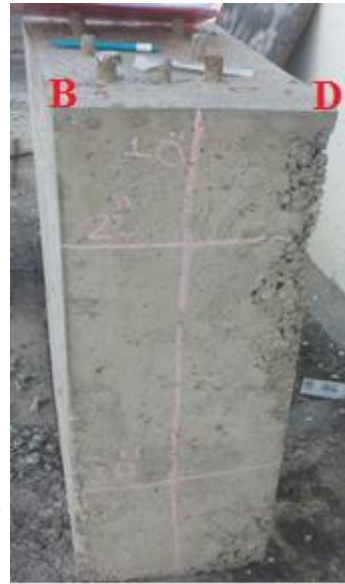
Şekil 93. Model 2 BD kesiti üzerinde yapılan 2B’lu ölçümler a) Profil numaraları, hatları ve yönleri b) BD kesiti 2B’lu ölçüm yerleri
