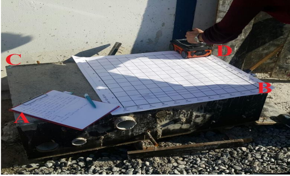
Şekil 110. BD kesiti üzerinden başlayarak oluşturulan profillerden ölçüm alımı
