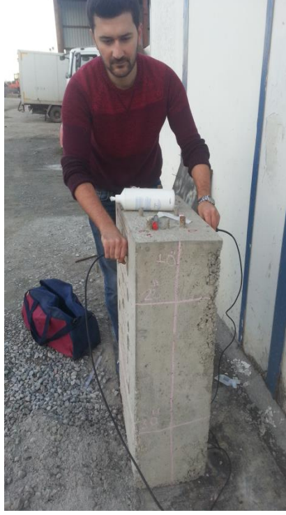
Şekil 62. Model 2 ultrasonik hız ölçümü
