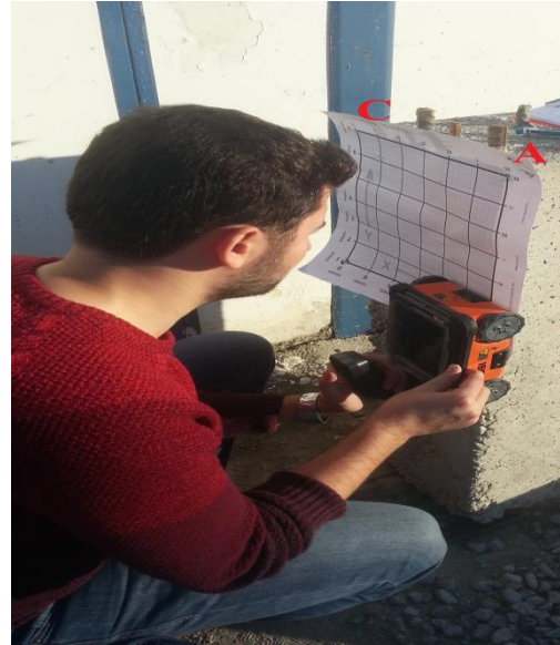
Şekil 100. Model 2 CA kesiti 3B ölçümler a) Grid kağıdının kolon üzerindeki konumu b) CA kesiti 3B’lu görüntü için profillerden yapılan ölçümden bir görünüm
