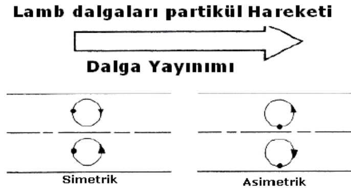
Şekil 26. Lamb dalgaları partikül hareketi (Mix, 2005).
