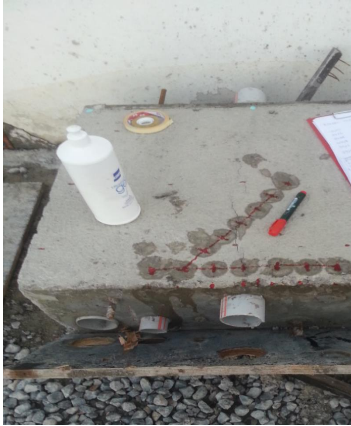
Şekil 65. Model 3 ultrasonik kırık-çatlak tespiti ölçüm profilleri
