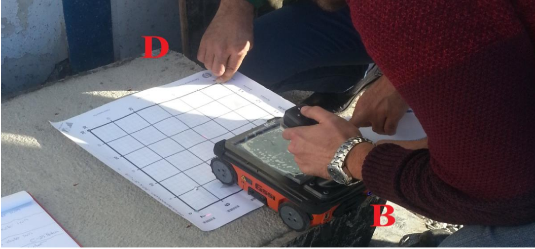
Şekil 113. BD kesiti üzerinden başlayarak oluşturulan profillerden ölçüm alımı
