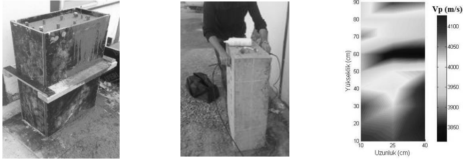
Şekil 1. Düşey betonarme numunesinin görüntüsü, ultrasonik hız ölçüm görüntüsü ve ultrasonik hız haritası.
