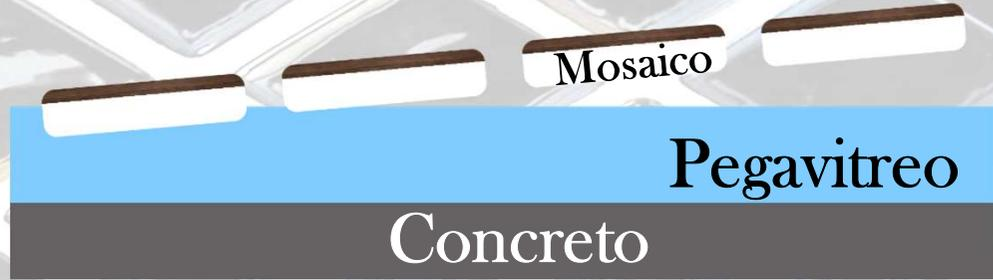
2. Se presiona el material, lo que permite que el Pegavitreo se extienda a las juntas y abrace a la ficha balanceando el nivel de fijación de cada mosaico en una etapa.
