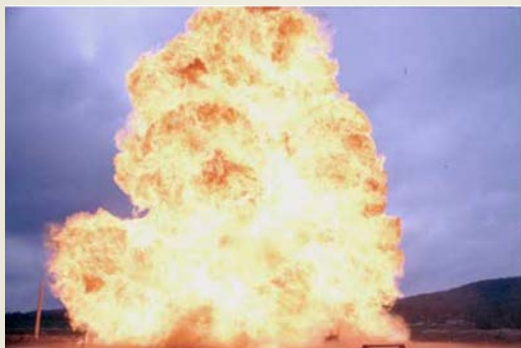
Fireball from propane BLEVE experiment. ii
