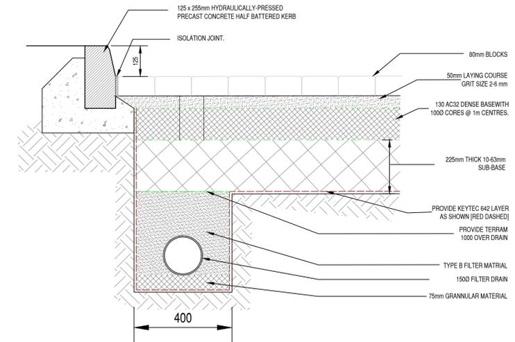
**LINEAR DRAIN / PERMEABLE BLOCK PAVING
