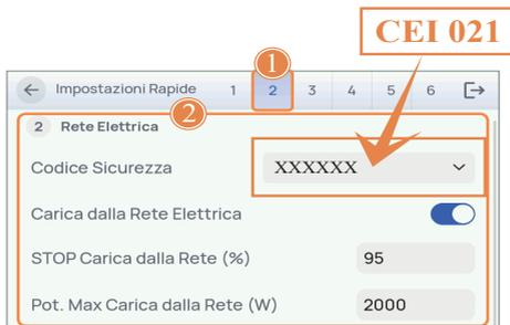
Accedere all'interfaccia del Passaggio 2 per impostare i parametri di rete.
