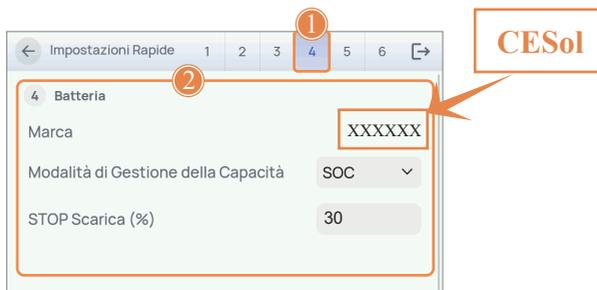
Accedere all'interfaccia del Passaggio 4 per impostare i parametri della batteria e selezionare CESol.
