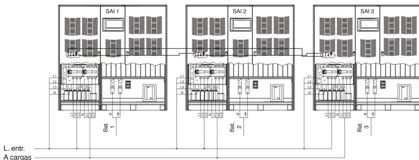
Fig. 26. Ejemplo conexión 3 SAI XTRA-P de 400 kVA.
