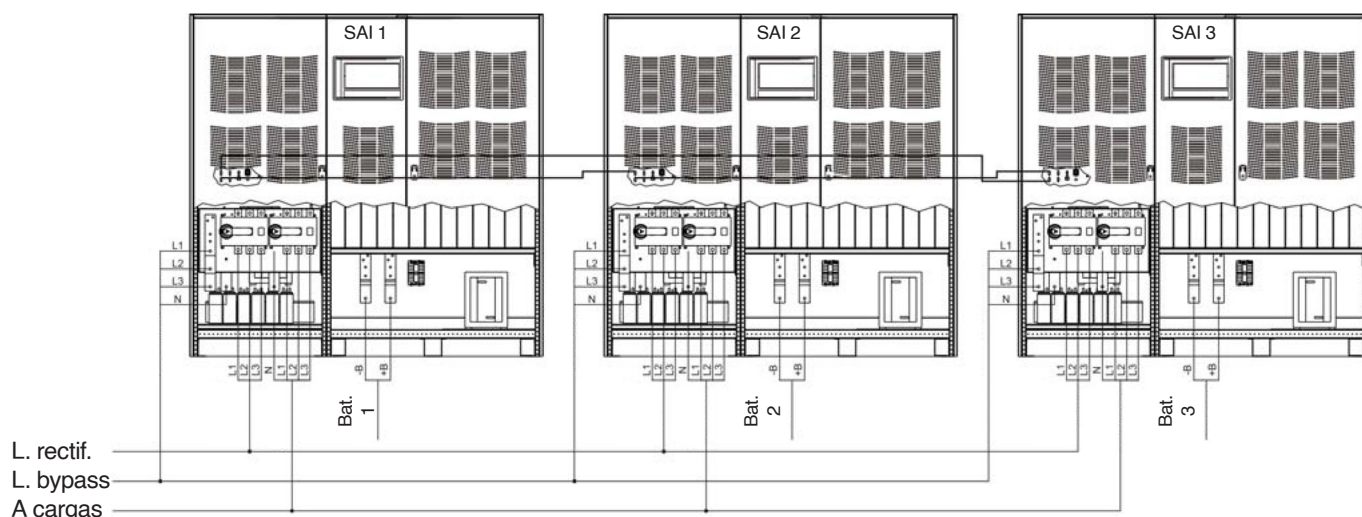
Fig. 25. Ejemplo conexión 3 SAI XTRA-P de 400 kVA, con red de bypass independiente.
