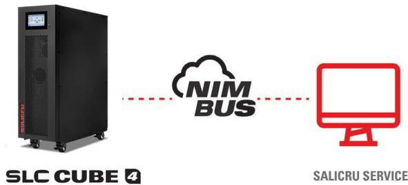
Fig. 52. Sistema de monitorización remota y de avisos directo al Servicio Técnico, el tiempo de respuesta se minimiza al máximo
