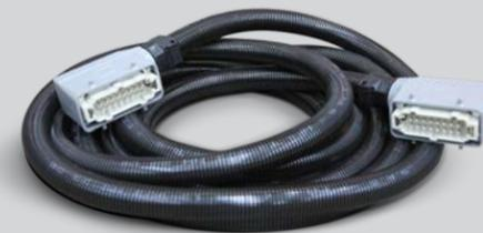
▲ **MANGUERA DE CONEXIÓN FLEXIBLE, COMPACTA Y RESISTENTE A IMPACTOS E HIDROCARBUROS.** Transmite información procedente del motor y del alternador a la central. La longitud de manguera estándar suministrada por HIMOINSA es de 6 metros y como opcional se encuentra disponible hasta 19 metros.
