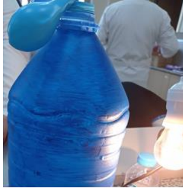
Resim 2. Elektrik lambası ışığı ile balonun şişirilmesi
