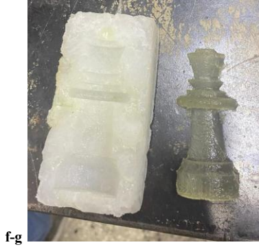
Görsel-8 Silikon kalıp üretimi epoksi malzeme ürün üretimi
