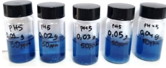
Şekil 13. 50 ppm konsantrasyonda ve pH=5'te farklı polimer miktarlarındaki (0,01g, 0,02g, 0,03g, 0,04g ve 0,05g) çözeltiler
