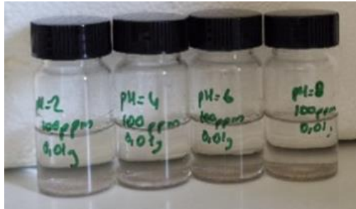
Şekil 8. 0,010 gram P(EGDMA-VPRDN)-TiO 2 -Fe 3 O 4 polimeri üzerine pH=2,4,6,8 ile hazırlanan Nikotin çözeltilerinin eklenmesi
