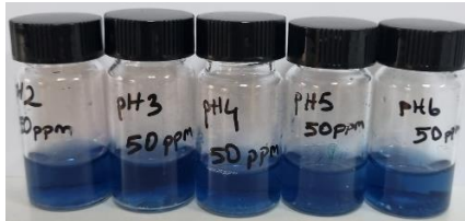
Şekil 11. Farklı pH değerlerinde adsorpsiyon işleminin gerçekleştirilmesi
