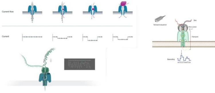
Şekil 4. Oxford nanopore teknolojisi çalışma prensibi. (Willeman, 2019; Chera vd., 2024)
