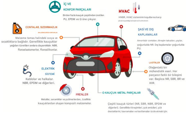
Şekil 4. Bir binek araçta kullanılan kauçuk parçalar (Barrios, Verdejo, López-Manchado, Santana, 2023).
