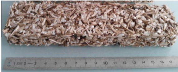
Şekil 6. Ayçiçeği sapından elde edilmiş kompozit panel (Mati-Baouche vd., 2016).
