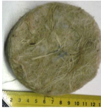
Şekil 10. Kenaf lifi akustik deney örneği (Berardi and Iannace, 2015).
