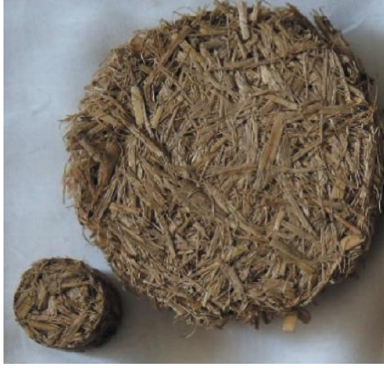
Şekil 7. Şeker kamışı posası lif kompozit (Haghighat vd., 2023).
