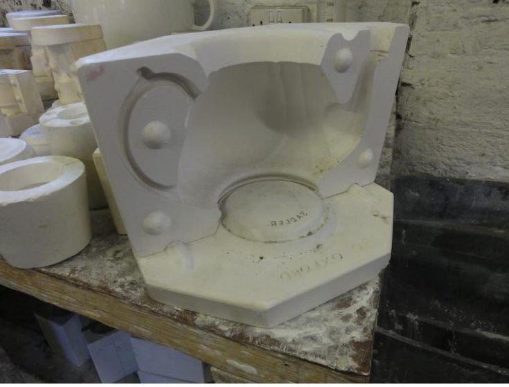
Şekil 2. Gladstone Pottery Museum’da çaydanlık üretimi için kullanılan çok parçalı alçı kalıp.
