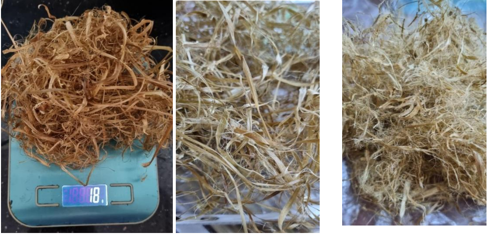
Şekil 4: Elle soyulan lifler a) Lif ağırlığı, b) Soyulmuş taranmamış lif c) Soyulmuş mekanik işlem görmüş lif
