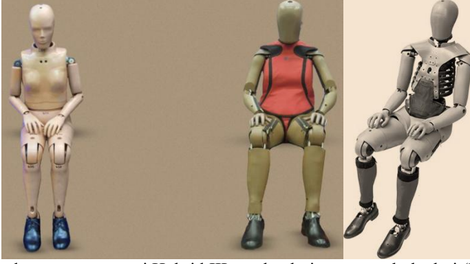
Şekil 5. Modern çarpışma testi Hybrid III mankenleri ve sensör bölgeleri (Humanetics Innovative Solutions'dan (2023) uyarlanmıştır.)
