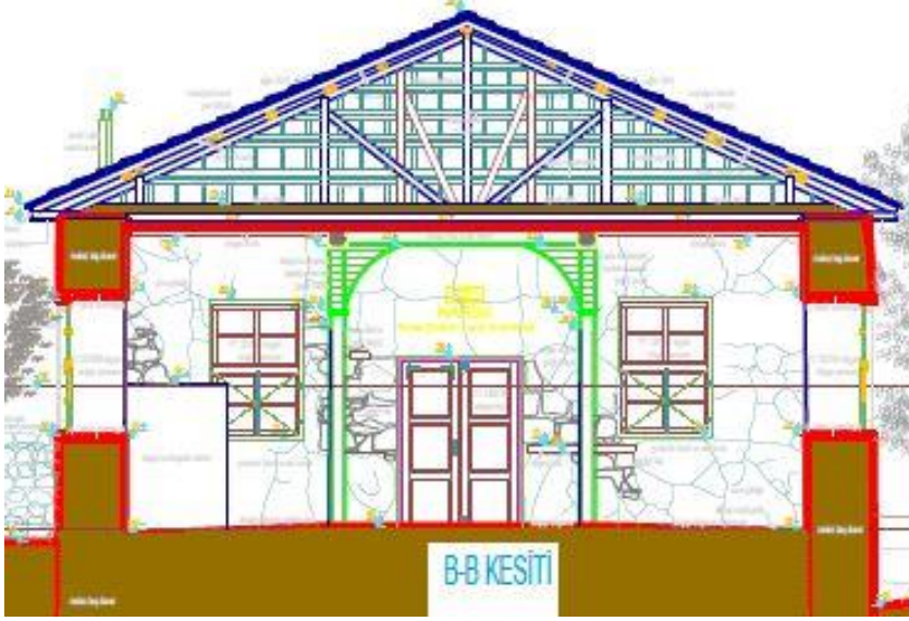
Şekil 4: Bayırbağ Köyü Camii BB kesiti, (VGM arşivi, 2025)
