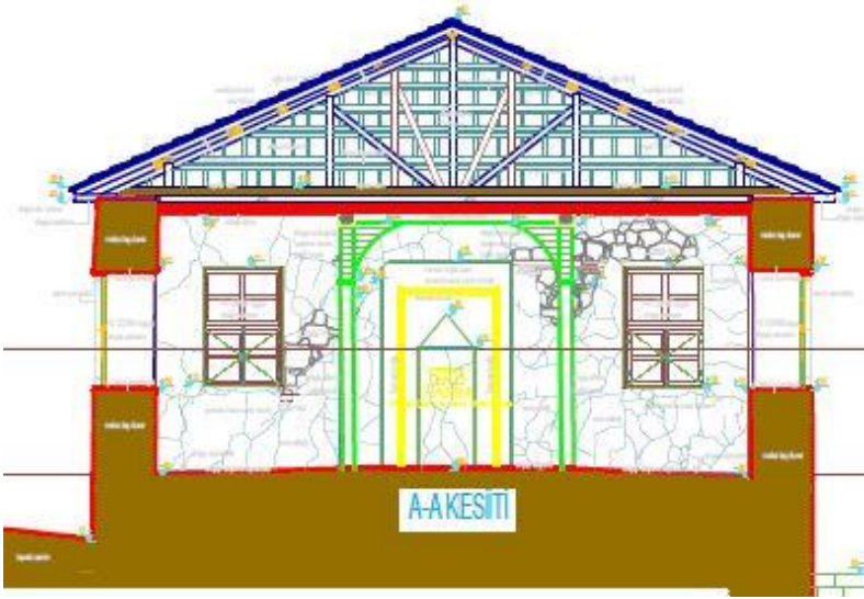
Şekil 2: Bayırbağ Köyü Camii AA kesiti, (VGM arşivi, 2025)
