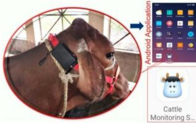
Şekil 1. Süt sığırlarının aktivite takibi için geliştirilen MOONitor cihazı. Boyuna takılan bu IoT tabanlı sistem; sıcaklık sensörü, GPS modülü ve üç eksenli ivmeölçer aracılığıyla hayvanın fizyolojik ve davranışsal verilerini toplar. Toplanan veriler, mikrodenetleyici ve GSM modülü üzerinden IoT sunucusuna iletilerek işlenir ve XGBoost ile Random Forests algoritmaları kullanılarak yürüyüş, otlama, uzanma, ayakta durma ve geviş getirme gibi temel aktiviteler yüksek doğrulukla sınıflandırılır (D. Dutta et al., 2022).
