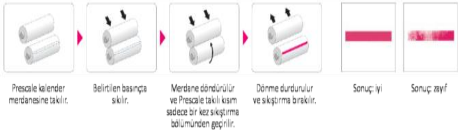
Şekil 5. Prescale ile kalender merdanesinin ayarlanması
