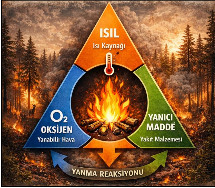
Şekil 1. Orman yangınlarında yanma reaksiyonunun gerçekleşebilmesi için gerekli olan yangın üçgeni; atmosferik oksijen, ısı girdisi ve bitkisel yanıcı yükün etkileşimini şematik olarak göstermektedir.
