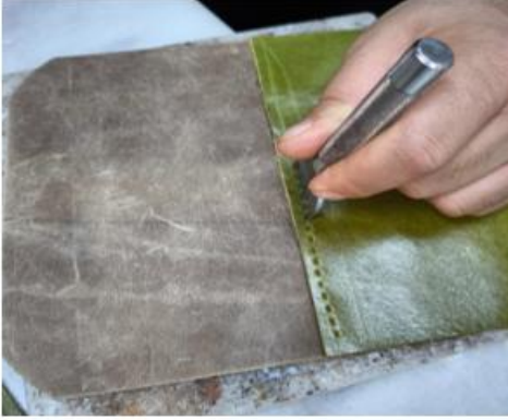
Resim 27. Kapağı punch ile delme
