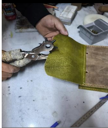
Resim 35 ve 36. Toka deliklerini açma
