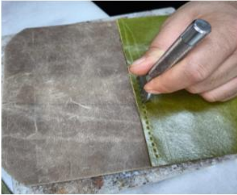
Resim 27. Kapağı punch ile delme
