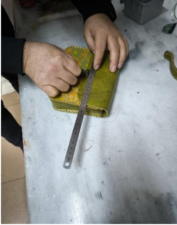
Resim 35 ve 36. Toka deliklerini açma
