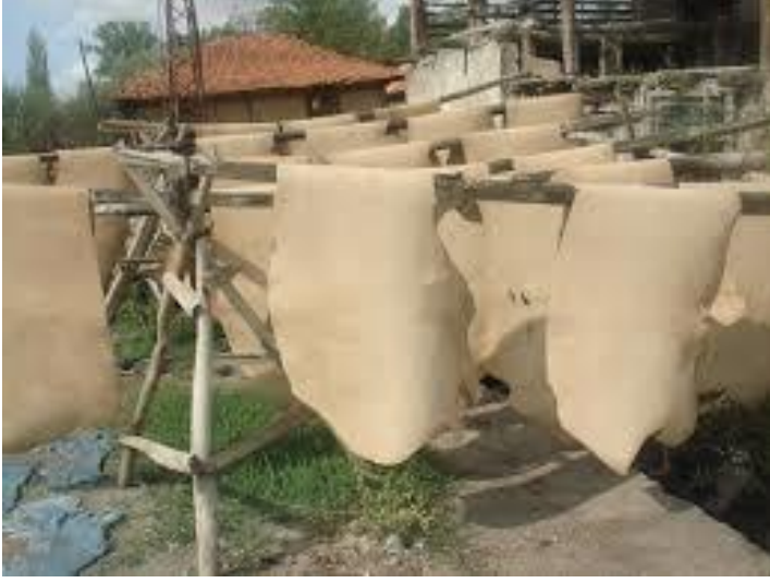
Resim 9. Vaketa deri güneşte kurutma
