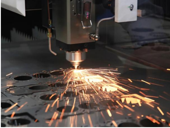
Resim 3. Fiber lazer ile yapılan bir malzeme kesme işlemi [8].
