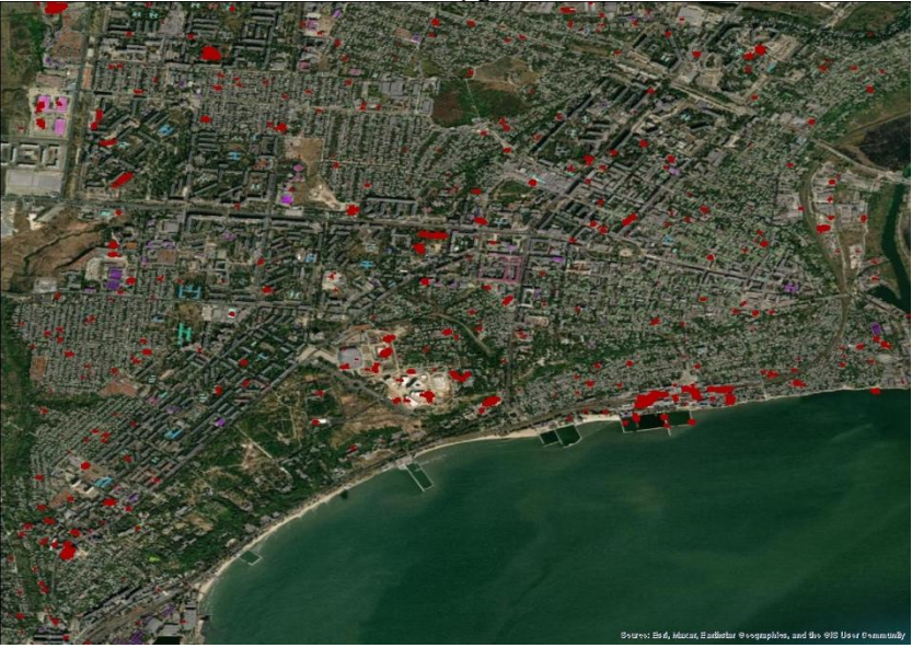
Şekil 5: Mariupol Merkez bölgesindeki yapıların yakınlaştırılmış backscatter analizi sonuç görüntüsü
