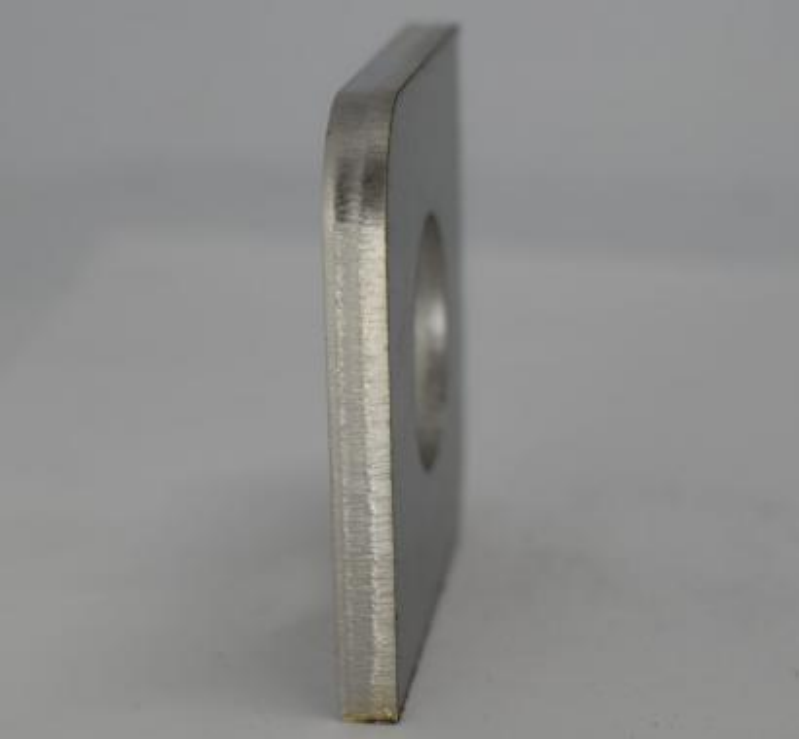
Resim 6. Karbon lazer ile yapılan paslanmaz kesme işlemi [13].
