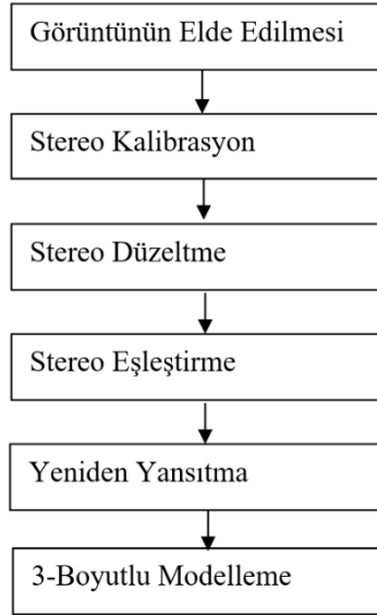
Şekil 5: Stereo görüş ile 3-boyutlu modelleme adımları
