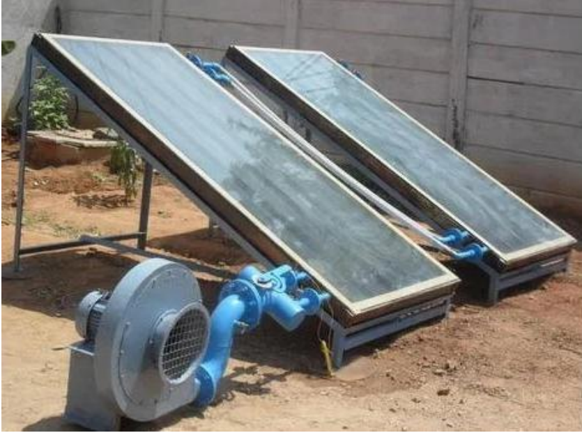
Şekil 1. Hava ısıtmalı güneş kolektörü (Indiamart, 2025)
