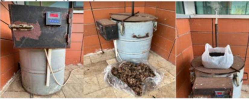
Şekil 1. Biyokömür eldesinde kullanılan biyokömür sobası
