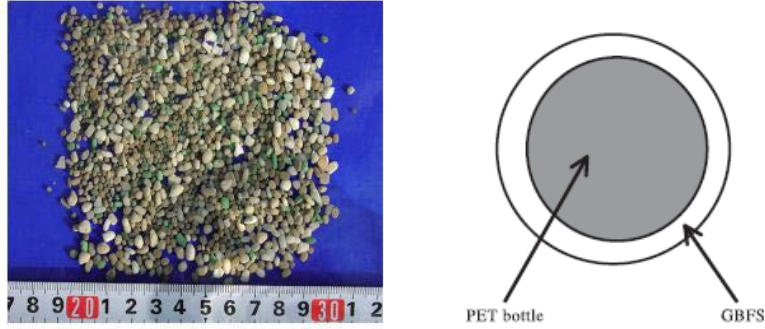
Resim 3. a) Hafif agregânın şekli b) Hafif agregânın kesiti (Choi ve ark., 2005)
