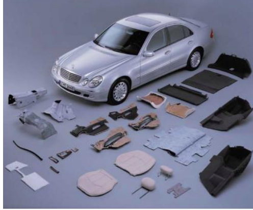
Şekil 6. Keten, kenevir, sisal ve yün içeren Mercedes Benz E sınıfı parçalar. (Akampumuza, Wambua, Ahmed, Li, Qin, 2016)
