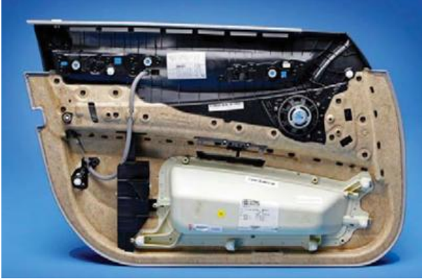
Şekil 8. BMW 7 Sedan serisi sıkıştırma ile kalıplanmış ve BASF akrilik kopolimerlerden yapılmış kapı alt paneli (Shinoj, Visvanathan, Panigrahi, and Kochubabu, 2011).
