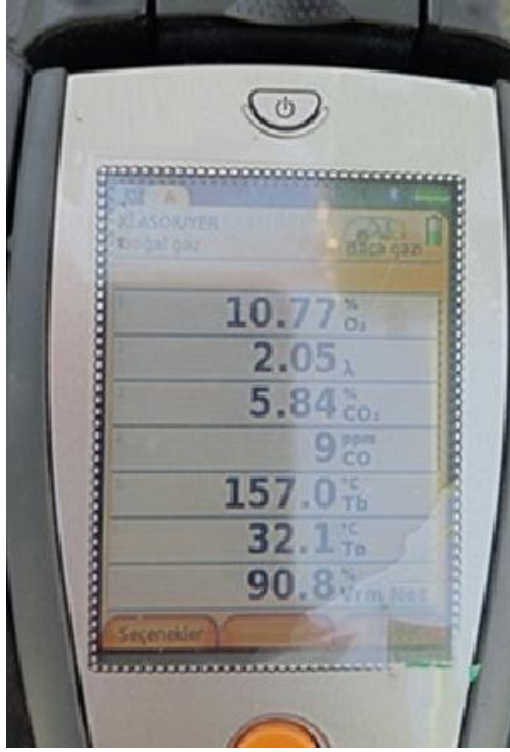
Şekil 9. Kazan Baca Gazı Ölçüm Ekranı
