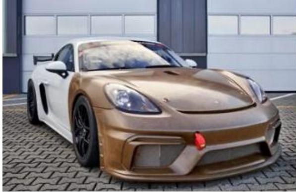
Şekil 4. Doğal elyaf kompozit gövdeye sahip Porsche Cayman 718 GT4 CS MR modeli https://www.compositesworld.com erişim: 22.08.2023).
