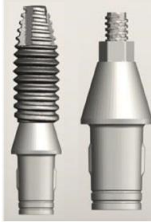
Şekil 5. İmplant ve Ti-base (titanyum taban) abutment 3D tasarımı (Gökay et al., 2024)
