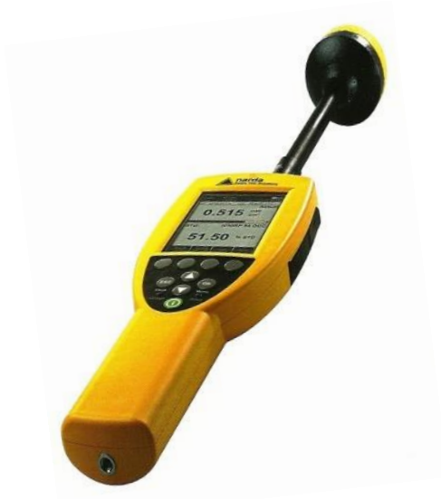
Şekil 2. NARDA NBM-550 elektromanyetik ölçer ile EF0691 kodlu probu
