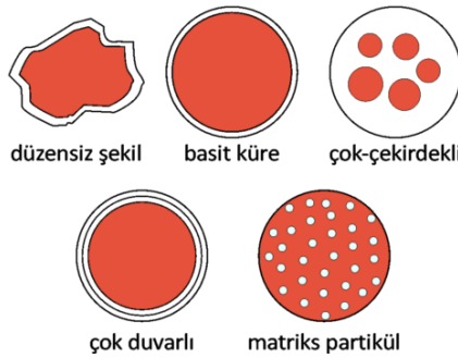
Şekil 2. Mikrokapsül yapıları (Eyüpoğlu & Kut, 2016)
