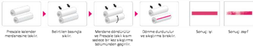
Şekil 5. Prescale ile kalender merdanesinin ayarlanması
