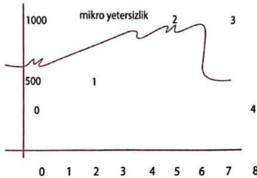
Şekil.11 : Bağın Yüklenmeye Karşı Gösterdiği Uzama Eğrisi
