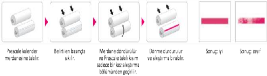
Şekil 5. Prescale ile kalender merdanesinin ayarlanması
