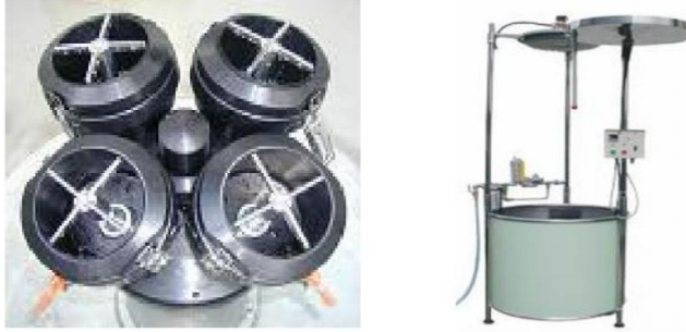
Şekil 9. Bundesmann su iticilik test cihazı (Özsevinç, 2012).
