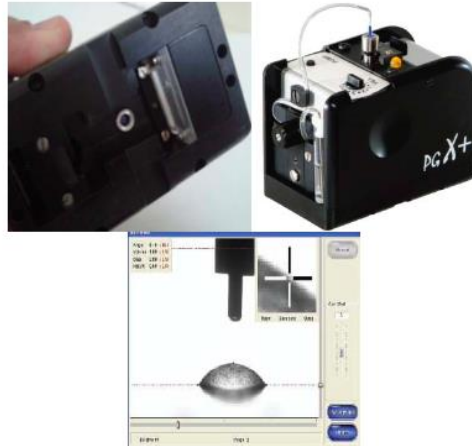
Şekil 2.14. Thwing-Albert PGX Gonyometre Cihazı ve Ölçüm Programı
