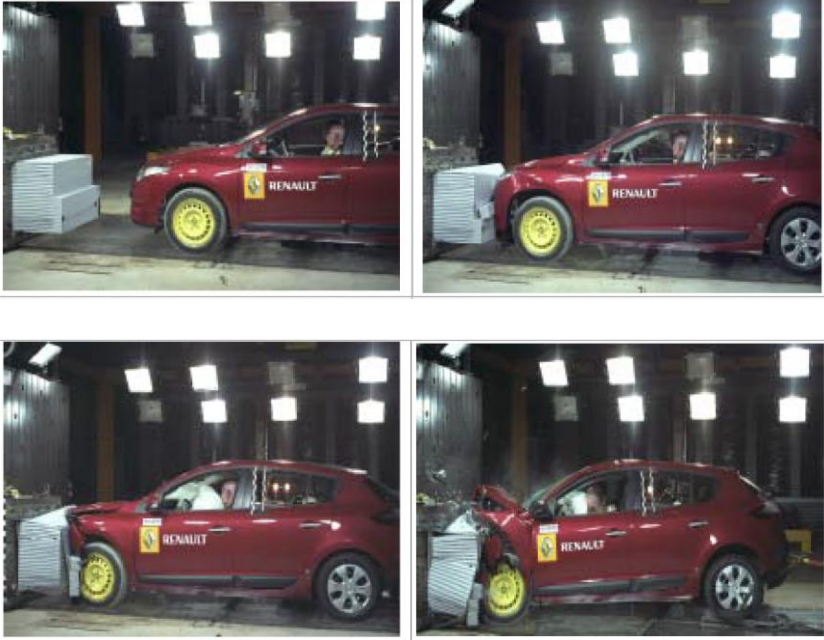
Şekil 1. Renault Mégane önden tam çarpışma testi görüntüsü (Abdul Samad ve ark., 2022).
