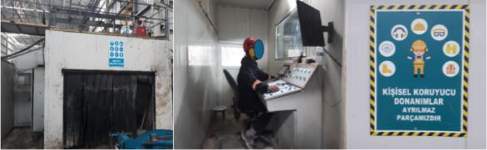
Şekil 1: Segment Fabrikası Kabin Operatörüne Yönelik Gürültüden Korunma Önlemleri
