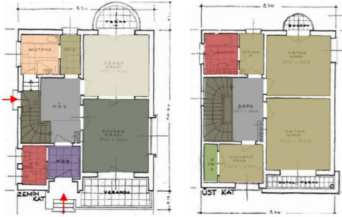
Şekil 9. Ankara Tasarruf Evleri Projesi Tip I zemin kat ve birinci kat planı
